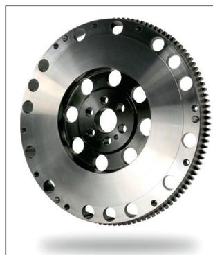
Competition Clutch-Schwungscheiben sind einteilig und werden aus geschmiedetem 4140er Stahl gefertigt. Dies schließt das Lösen des Zahnkranzes von der Scheibe aus und verringert die Möglichkeit des Verzugs der Reibfläche. Je nach Fahrzeug wiegen die Schwungscheiben zwischen 3,5 und 8 kg.
